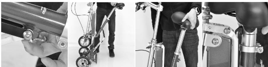
Step 3. 打開立管上方快拆，車手旋轉180°並下壓立管，關閉快拆。
