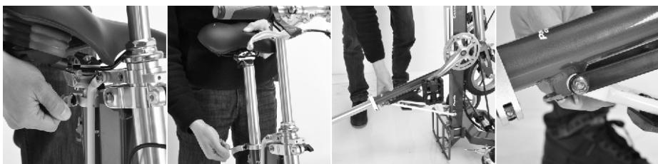
Step 3. 側壓打開主管下方扣住前叉的彈簧鉤。
