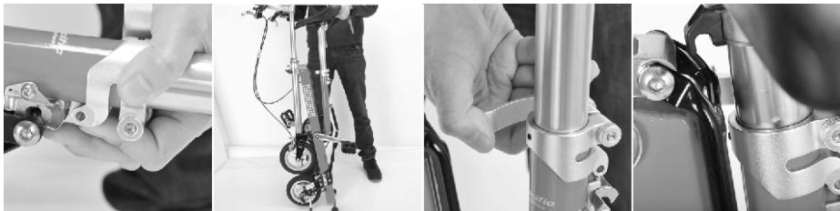
Step 3. 打開立管上方快拆，向後收折車手並下壓立管至輕碰座墊為止。關閉快拆。
