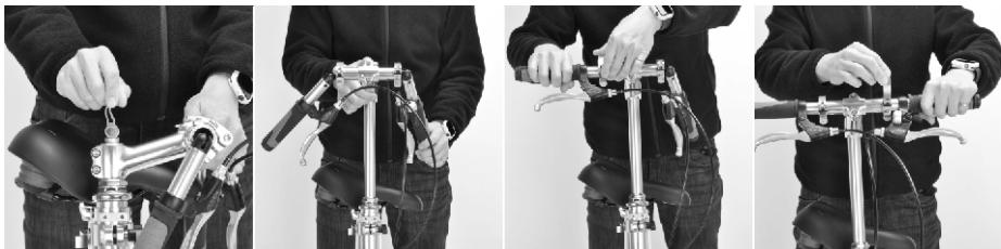
Step 2. 打開座管束快拆將座桿拉伸至適當高度。
