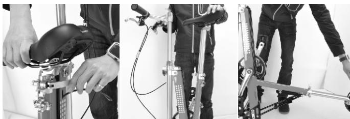
Step 3. 側壓打開主管下方扣住前叉的彈簧鉤。
