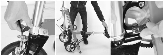
Step 2. 鬆開座管連桿固定卡榫，使座管脫離支撐桿並向頭管方向靠攏。打開座管束快拆，旋轉座椅90度讓座桿頭部黑色卡榫扣住頭管連桿最上方橫桿，之後關閉座管束快拆。
