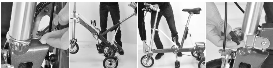
Step 4. 展開折疊腳踏。再次調整車手與座桿高度並確定前輪與車身呈一直線(注意座桿勿超過安全線標示)。
