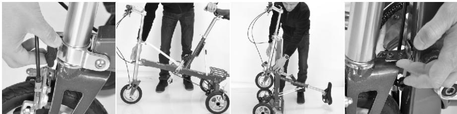
Step 2. 鬆開座管連桿固定卡榫，使座管脫離支撐桿並向頭管方向靠攏。打開座管束快拆，旋轉座椅90度讓座桿頭部黑色卡榫扣住頭管連桿最上方橫桿，之後關閉座管束快拆。
